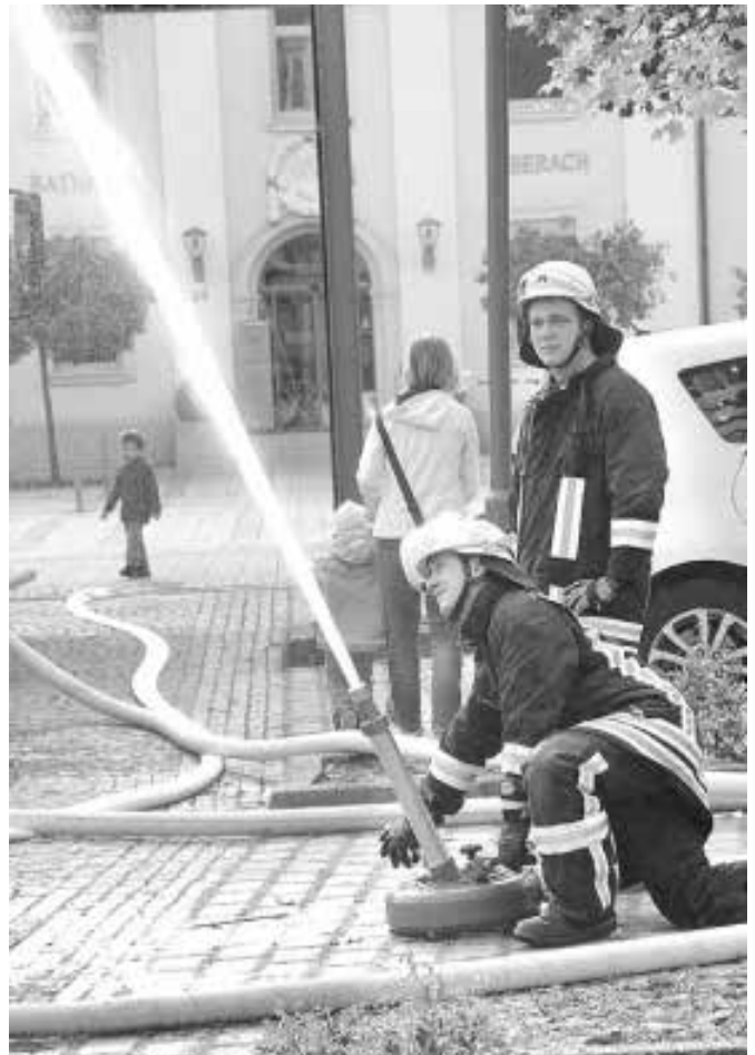
Ein Monitor im Einsatz – durch ihn kann eine besonders große Menge an Wasser eingesetzt werden.
