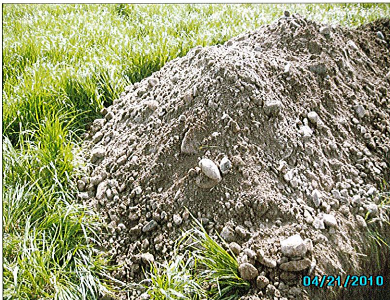
Abb. 6: Baggergut aus Schurf S 2, stark sandige Kinzigsschotter
