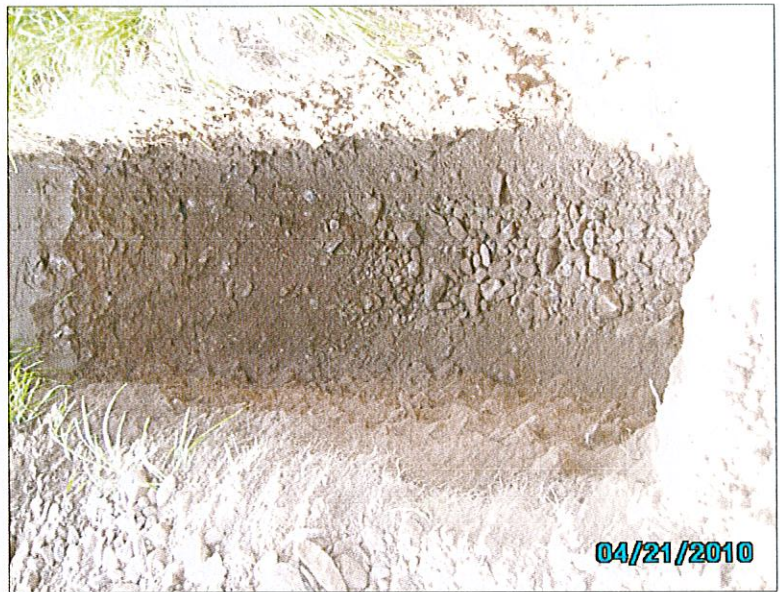
Abb. 6: Baggergut aus Schurf S 2, stark sandige Kinzigsschotter
