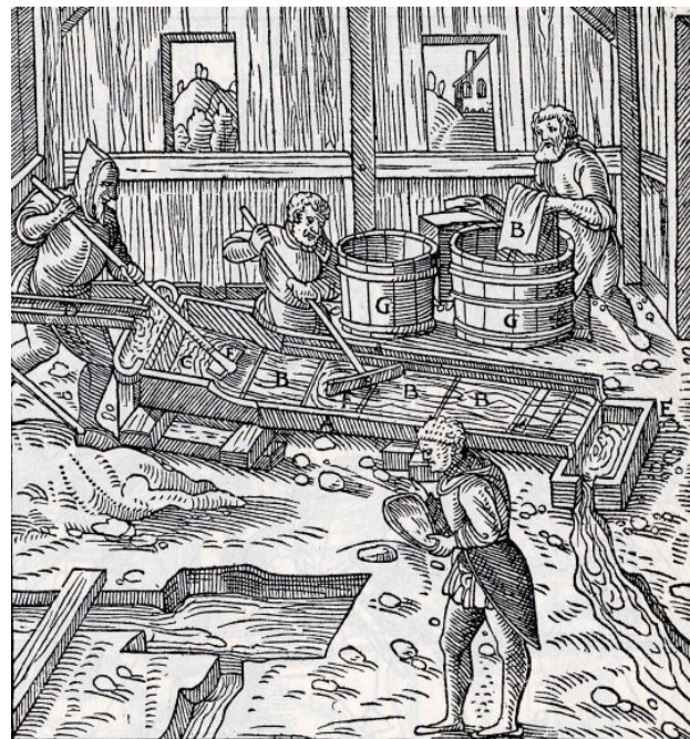
Abb. 4-1: Schlämmen von gepochten Erzmaterialien (Quelle: AGRICOLA 1556)
