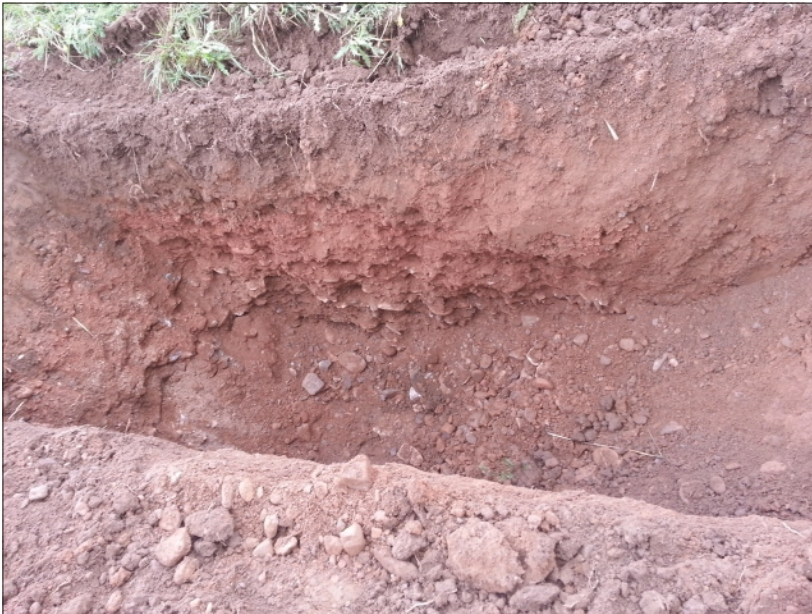
Abb. 8: Wassermarken (Mn-/Fe-Ausfällung) in Schurf S 3, gut erkennbare die eingeregelter Grobkomponenten auch "Dachziegellagerung" genannt
