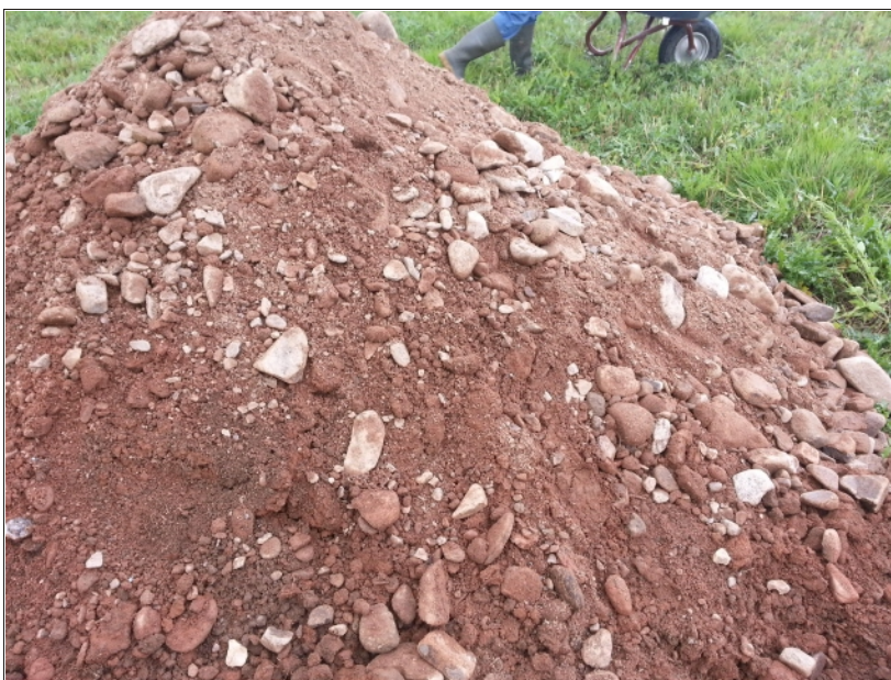
Abb. 9: grobkiesiges, teils steiniges Baggergut aus Schurf S 3.
