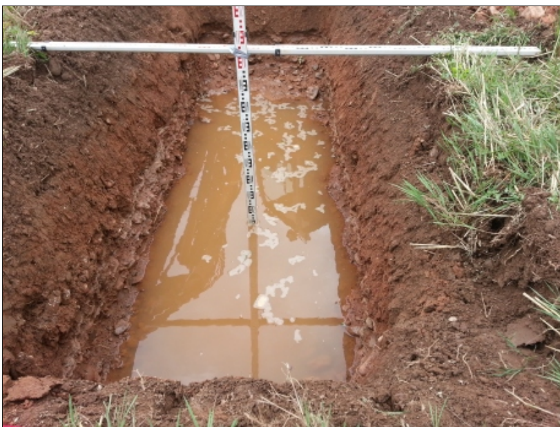
Abb. 12: Wasserstand in Versickerungsversuch VV 1 am Versuchsende
