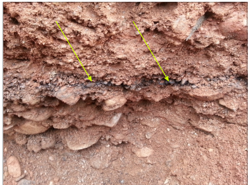
Abb. 9: grobkiesiges, teils steiniges Baggergut aus Schurf S 3.
