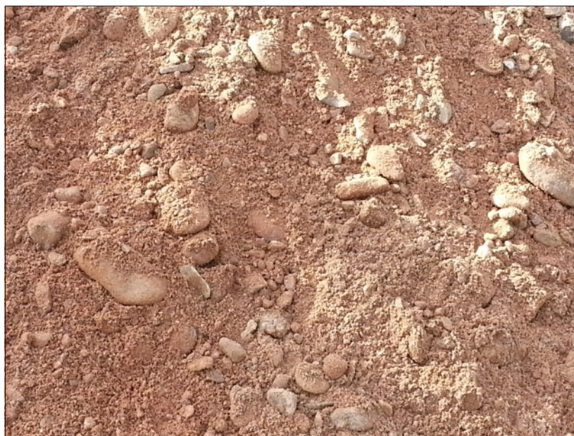
Abb. 6: Baggergut Schurf S 2 Detail stark sandige Kinzigsschotter
