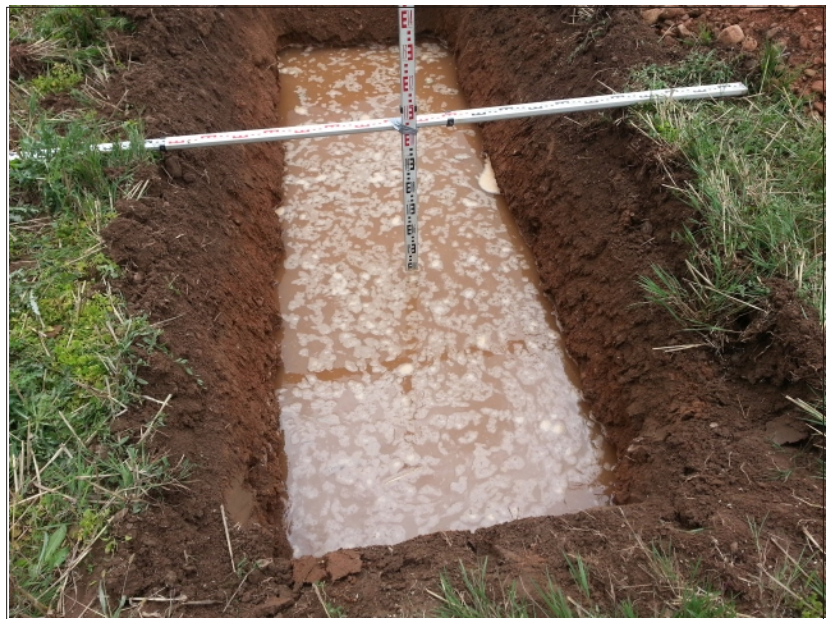
Abb. 12: Wasserstand in Versickerungsversuch VV 1 am Versuchsende
