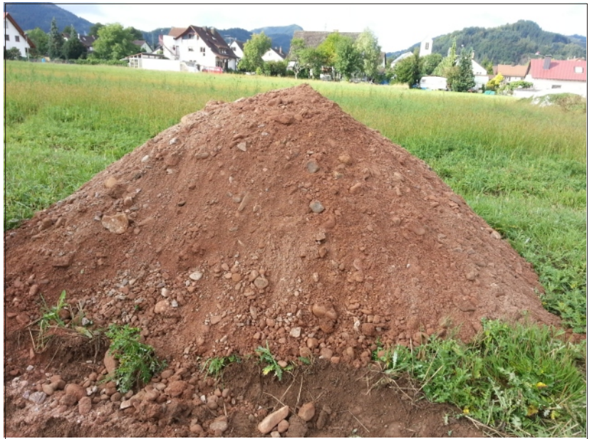
Abb. 6: Baggergut Schurf S 2 Detail stark sandige Kinzigsschotter
